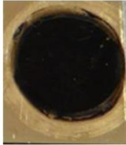
FIGURA 49. Macrografia da amostra de bronze com camada de ouro, mostrando área exposta ao meio corrosivo durante sete dias e então polarizada anodicamente.
