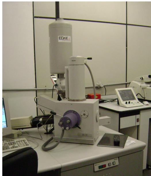
FIGURA 12. Microscópio eletrônico de varredura acoplado a espectrômetro de energia dispersiva de raios-X (EDX) utilizado.
