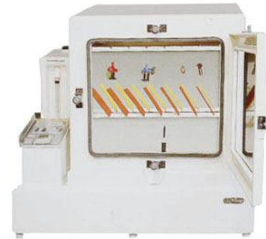
Corrosão Kesternich – SO 2
