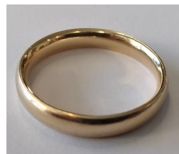
Aliança 18 Quilates utilizada para análise da composição elementar sem danificá-la e medição em 30 segundos.
